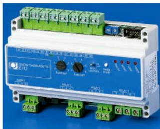
Das elektronische Steuergert wertet die Witterungseinflsse aus und erfaft ber angeschlossenen Sensoren Temperatur und Feuchte.
