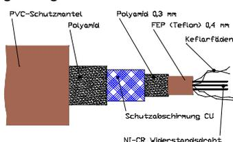
ThermoNetz® Freiflächen-Heizelemente werden nach DIN/VDE 0700/241 gefertigt und haben das VDE Zeichen. Die Heizelemente werden einzeln gepruft und mit den jeweils notwendigen Kaltleiterlngen nach Planung geliefert.
